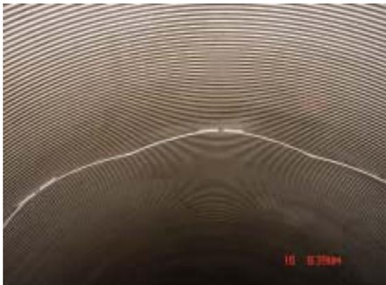
图 2 气缸内新型布油槽
