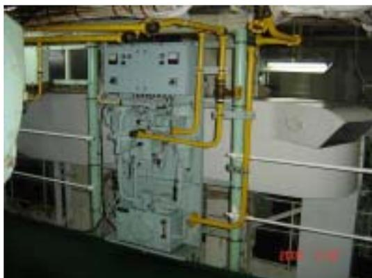
图 4 电子注油器泵站
