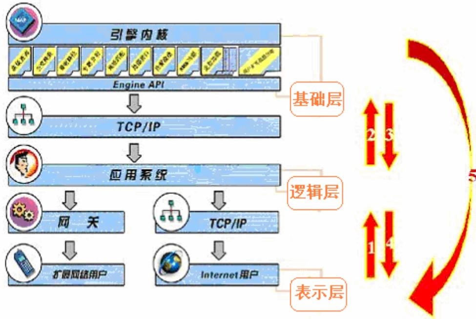
表示层是应用的用户接口部分,它担负着用户与应用间的对话功能。考虑到我国船舶管理公司现有的网络组件及未来发展趋势,我们准备采用以 C/S 为主, B/S 为辅的开发方式进行表示层的设计。在公司内部,利用现有 10M 以太网采用 C/S 方式;对于 Internet 用户,通过 Web 服务器采用 B/S 方式进行交互。
